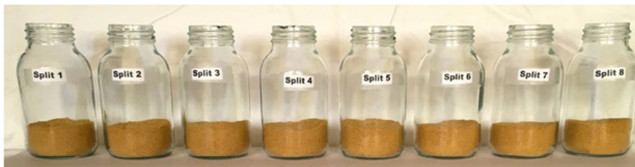
Fractions égales obtenues avec un diviseur rotatif
