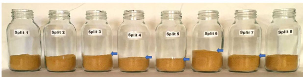
Fractions inégales obtenues avec un diviseur rotatif
