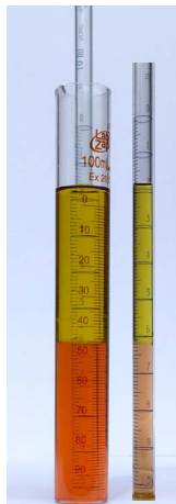
Figure 8. Exemples de délimitation correcte et incorrecte d'un prélèvement : A) un tube ouvert dans un liquide multiphasique (huile d'olive et vinaigre de vin rouge) dans un cylindre ; B) un tube ouvert dans un liquide multiphasique (huile d'olive et vinaigre de vin rouge) dans un erlenmeyer.
