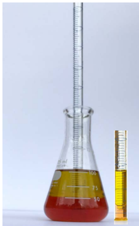
Figure 8. Exemples de délimitation correcte et incorrecte d'un prélèvement : A) un tube ouvert dans un liquide multiphasique (huile d'olive et vinaigre de vin rouge) dans un cylindre ; B) un tube ouvert dans un liquide multiphasique (huile d'olive et vinaigre de vin rouge) dans un erlenmeyer.
